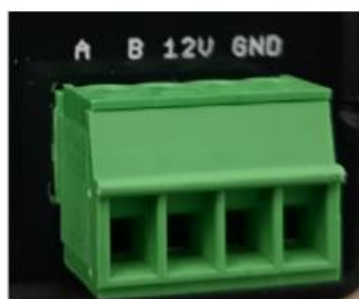
Svorkovnice vyhodnocovací jednotky v rozvaděči
