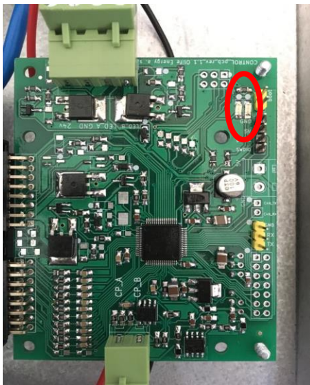
Obrázek 8: Pozice led diod indikující aktivní stav nabíjecí stanice
